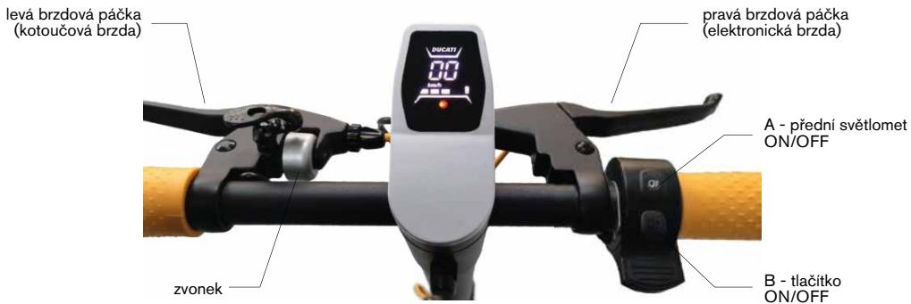
**Zapnutí (B):** Podržte stisknuté na tři sekundy tlačítko (B) pro zapnutí/vypnutí elektrické koloběžky.
