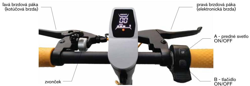
**Zapnutie (B):** Na zapnutie/vypnutie elektrickej kolobežky podržte toto tlačidlo (B) stlačené na dobu troch sekúnd.
