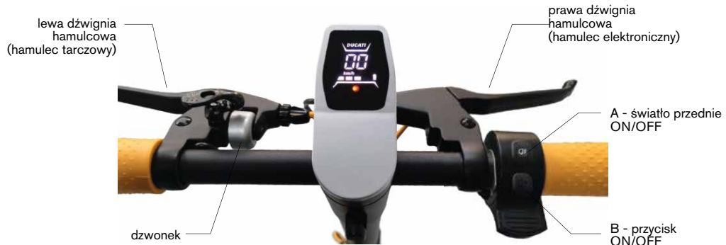
**Uruchamianie (B):** Przez trzy sekundy przytrzymać wciśnięty przycisk (B), aby włączyć/wyłączyć hulajnogę elektryczną.
