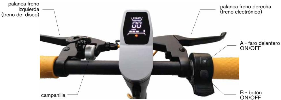
**Encendido (B):** Mantener pulsado este botón (B) para encender/apagar el patinete eléctrico durante tres segundos.
